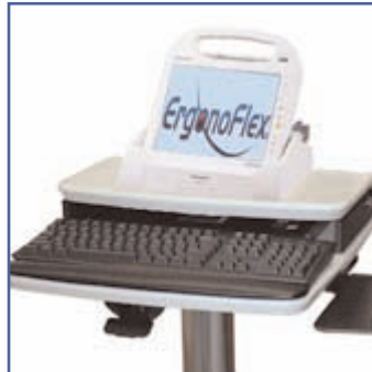
Docking station solidaire du plan supérieur pour éviter le vol.
